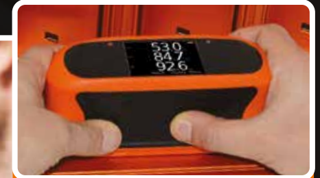
Medición del brillo y de la dispersión de luz
