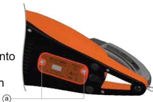
Para quitar la batería, desenroscar los dos tornillos de retención de la batería (a) en la parte posterior del instrumento y sacar la batería.
